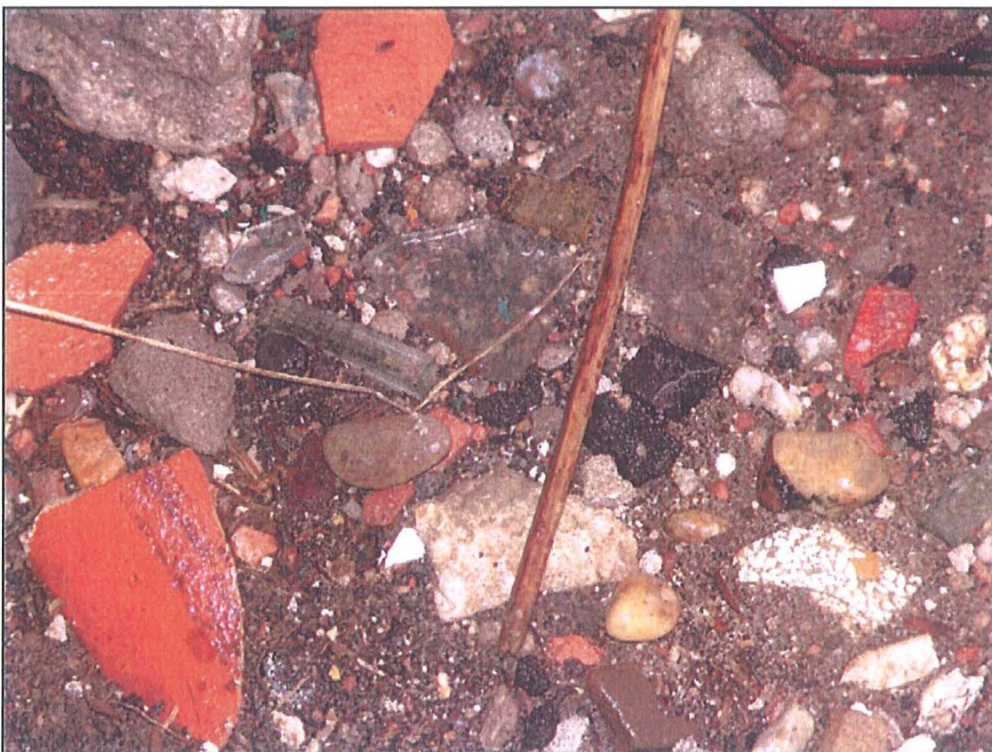
Foto 2: Scherven asbest op de grond rond de voormalige schuur
